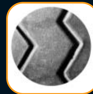
Šupinovitě zdrsnění • Scale-like roughening • Чешуеобразное взъерошивание
