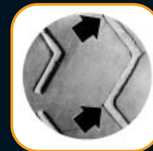
Tvorba otřepů • Burr formation • Образование заусениц
