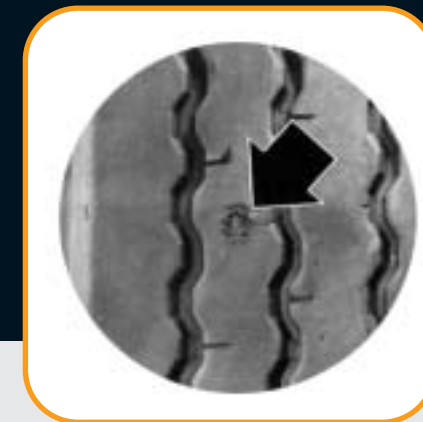
Hřebík (šipka) • Nail (arrow) • Гвоздь (стрелка)
